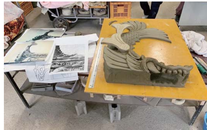
古写真より復元する鯨瓦のデザインを確認するための粘土型
